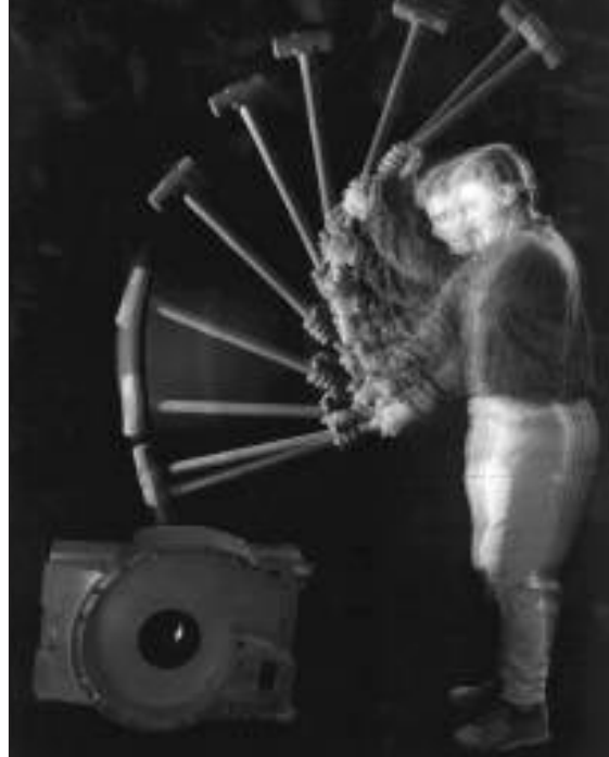
Polymera legeringar kan ges egenskapskombinationer som starkt överträffar egenskaperna hos de enskilda plastmaterial som ingår i legeringen. Här är ett mycket slagtäligt gräsklipparehjul från GE Plastics.
