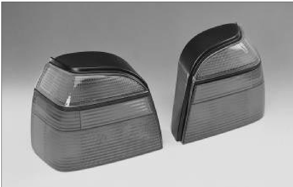
Baklyktor är ett typiskt exempel på svetsade plastprodukter. Här har formsprutade segment av olika färg vibrationsvetsats samman till ett "lyktglas". Foto: FAW Jacobi AB.
