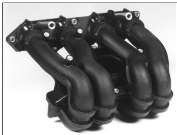
Ett snabbväxande användningsområde för amidplast av typ PA 6 eller PA 6.6 är insprutningsrör för bilmotorer. De är lätta och starka och har en slät insida som ger bra gasflöde. Ofta är plasten armerad med glasfibrer. Foto: Bayer AG.
