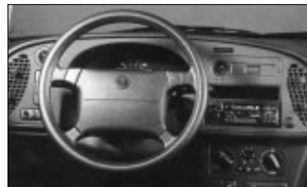
Bilindustrin arbetar systematiskt med att minska antalet plasttyper för att underlätta materialåtervinning. Ett exempel är den senaste SAAB 900 där ett antal olika material ersatts med plaster från samma materialgrupp.
