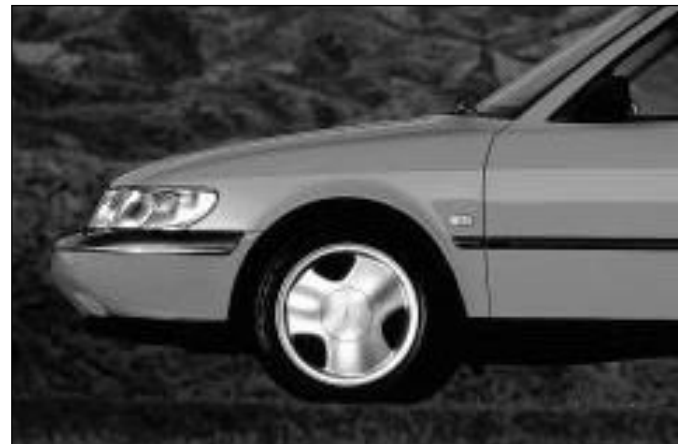
Olefinplasterna får allt större användning i krävande konstruktioner. Här polypropen i stötfångaren på Saab 900.
