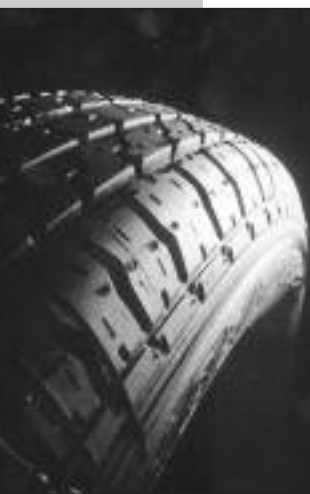
Beroende på vilka egenskaper som önskas tillverkas bildäck av både syntetiskt gummi, naturgummi eller kombinationer av dessa elaster.
